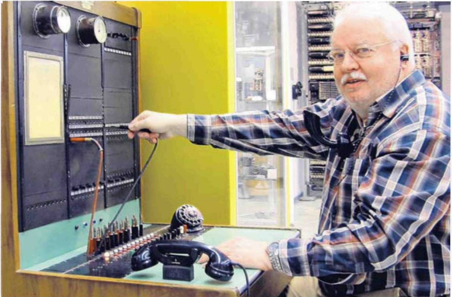
Stöpseln für eine reibungslose Verbindung: Herbert Stettner vom Förderverein des Fernmeldemuseums Aachen sitzt am Arbeitsplatz eines Fräuleins vom Amt. Diese Handvermittlungszentrale war im Fernmeldeamt Aachen bis Mitte der 1950er Jahre in der Vermittlung von Ferngesprächen im Einsatz. FOTO: HEIDRICH
